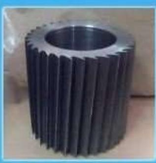
قطعه پس از ماشینکاری و عملیات حرارتی
